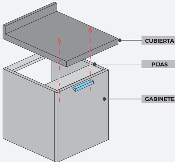
La cubierta se sujeta al mueble por medio de pijas instaladas por debajo de la cubierta.
